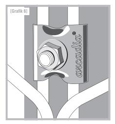
Befestigen Sie die U-Schiene oberhalb jedes Kreuzpunktes der Säule (alle 20 cm) an den dafür vorgesehenen Stanzungen mit jeweils einer Flachrundschraube, Sperrzahnmutter und Universalklemme.
