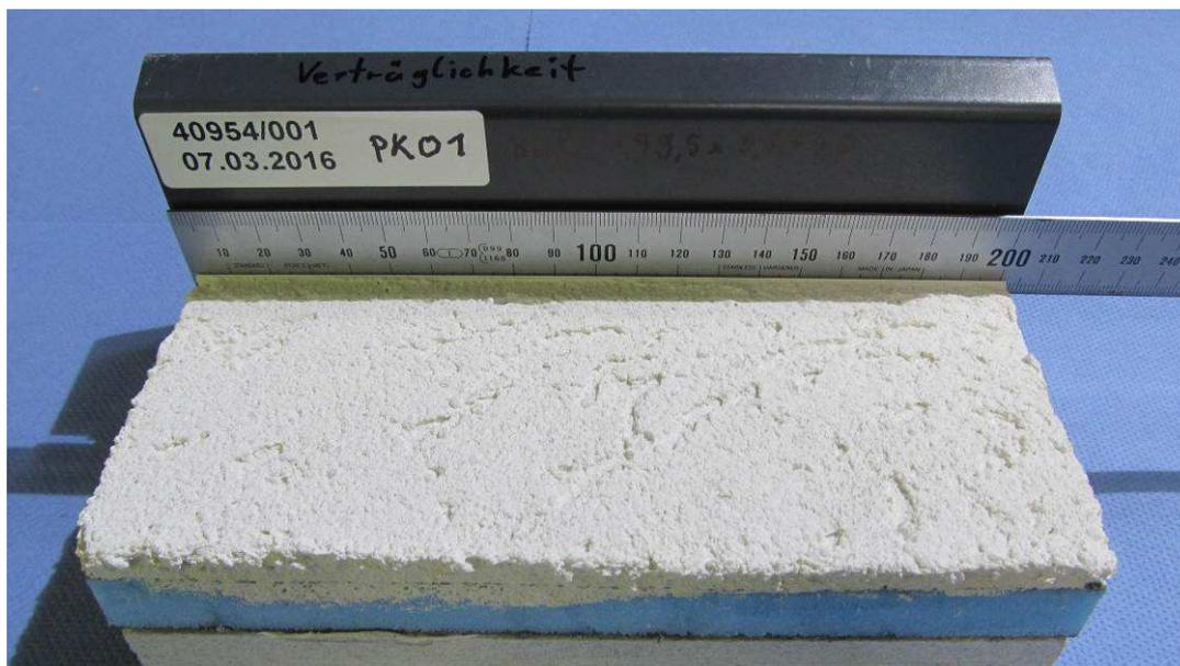
**Bild 2** Probekörperaufbau für die Prüfung nach Abschnitt 4.5
